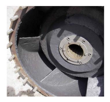
贝尔佐纳 (Belzona) 1311 (陶瓷 R 金属) 是一种用于重建并保护金属 免受侵蚀腐蚀影响的修复复合材料。
