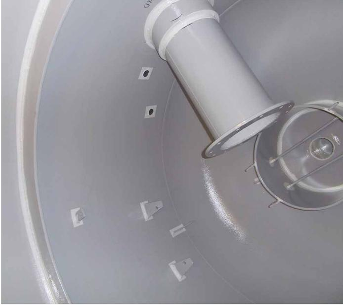
贝尔佐纳(Belzona) 1331 是一种双组分涂层系统, 可为在温度高达 50°C (122°F) 的连续浸泡环境下运行的设备提供耐侵蚀腐蚀保护。
