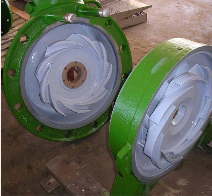
贝尔佐纳 (Belzona) 1341 (超滑金属) 是一种双组分涂层系统, 适用于提高流体处理设备的效率, 保护金属免受侵蚀腐蚀。
